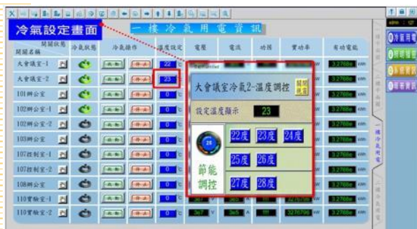
048館需量控制平台
